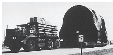
Рис. 3. Транспортировка реакторных отсеков на трейлере к месту захоронения
