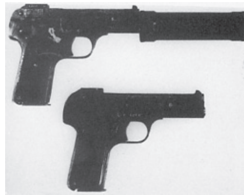
Рис. 4. Глушитель, расположенный эксцентрично по отношению к стволу (корейский пистолет «Тип 64»)
